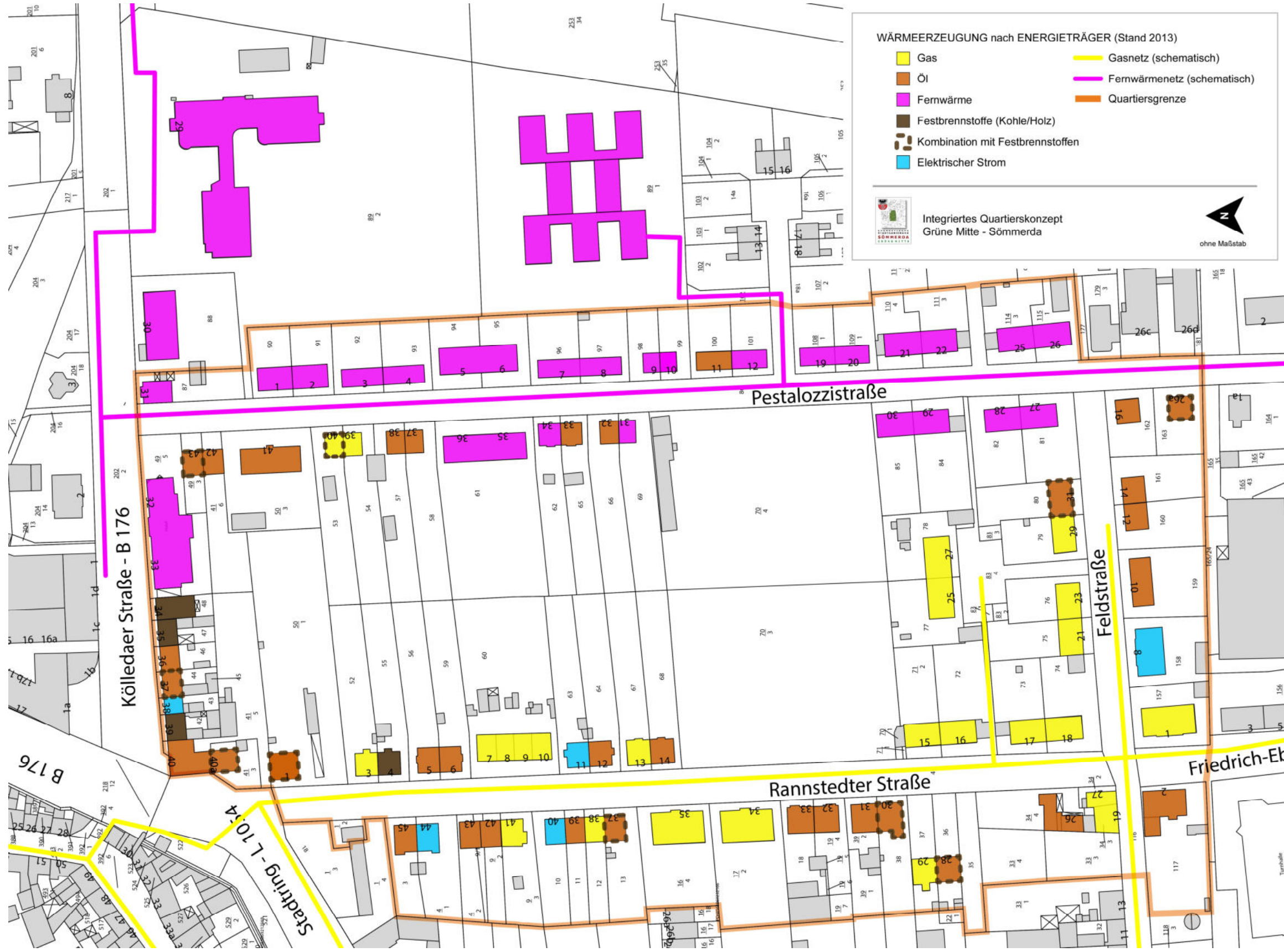
Abbildung 3-2 Übersicht der eingesetzten Energieträger im Gebäudebestand(Wärmeerzeugung) und Energienetze im Quartier (Stand 2013) 22
