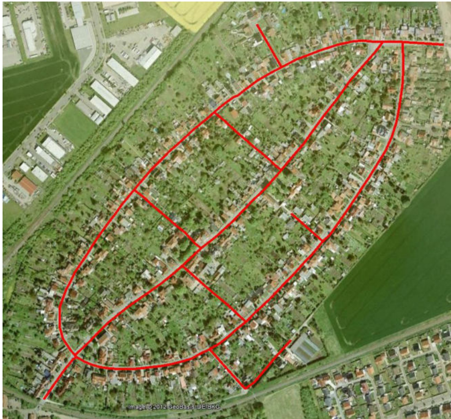
Abb. 30: schematischer Entwurf für eine mögliche Struktur eines Nahwärmenetzes auf dem Gartenberg (Quelle: EVF)
